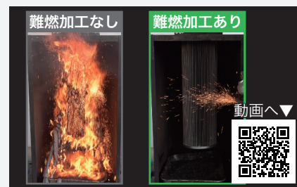
UL94V 燃焼試験「V-0」相当
